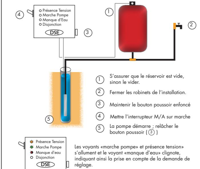
Lorsque le réservoir est rempli et que la pompe s'arrête, l'auto-réglage est terminé, l'installation est prête à fonctionner.
