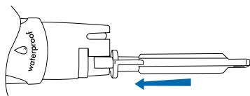
Insérez le bout de la clé dans la sonde puis tournez dans le sens inverse des aiguilles d'une montre pour la dégager.
