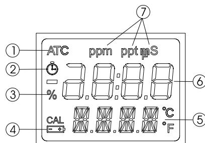
1. Indicateur de compensation automatique de température
