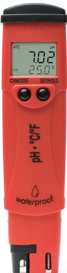
Avant d'utiliser ce testeur, installez d'abord l'électrode et dévissez le compartiment des piles pour retirer la languette.
