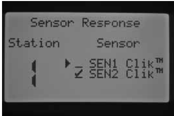
Uniquement la sonde 2 programmée pour la station 1
