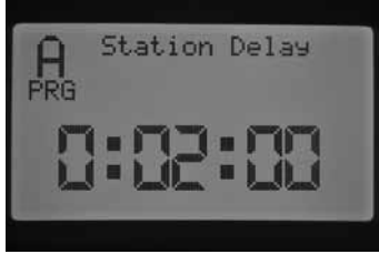
EXP : DÉLAI DE STATION POUR LE PROGRAMME A : 2 MINUTES
