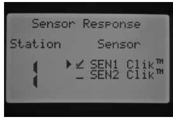
Uniquement la sonde 1 programmée pour la station 1
