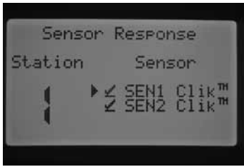
Les deux sondes programmées pour la station 1
