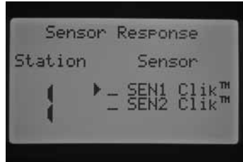
Aucune sonde programmée pour la station 1
