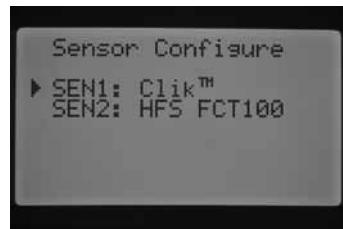
SEN 1 – SONDE DE TYPE CLIK SEN 2 – SONDE DE DÉBIT (HFS FCT100)
