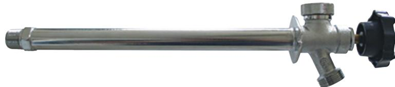
L'inclinaison du tube traversée de cloison permet au robinet de puisage de se purger automatiquement après chaque utilisation.
