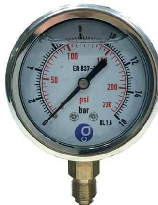
Le manomètre radial inox à glycérine permet de mesurer la pression des fluides gazeux et liquides qui ne sont pas très visqueux, cristallisants, ou corrosif aux alliages de cuivre et d'étain. Il est spécialement conçu pour résister aux hautes vibrations et aux chocs.
