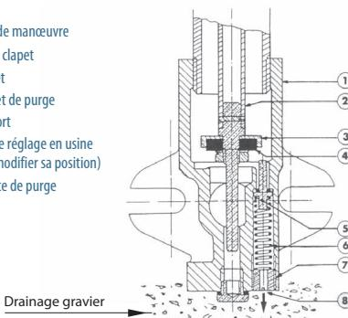
**INSTALLATION :** Il est recommandé d'éviter le contact direct de la terre avec la partie inférieure de la bouche, et de drainer l'écoulement de purge à l'aide de gravier exclusivement
