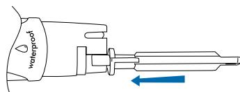
Insérez-là dans la cavité de l'électrode ainsi que le montre le schéma, tournez dans le sens inverse des aiguilles d'une montre.
