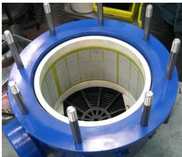
Tamis correctement installé
