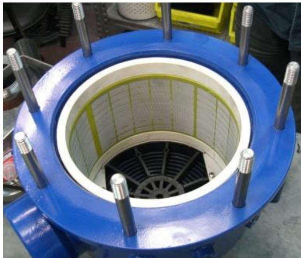
Tamis correctement installé
