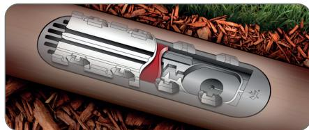
Le tuyau flexible en polyéthylène doit être doté de goutteurs à régulation de pression installés en usine tous les 33 cm. Le débit de chaque goutteur installé doit être de 2,3 litres par heure quand la pression amont est comprise entre 0,58 et 4,14 bars.
