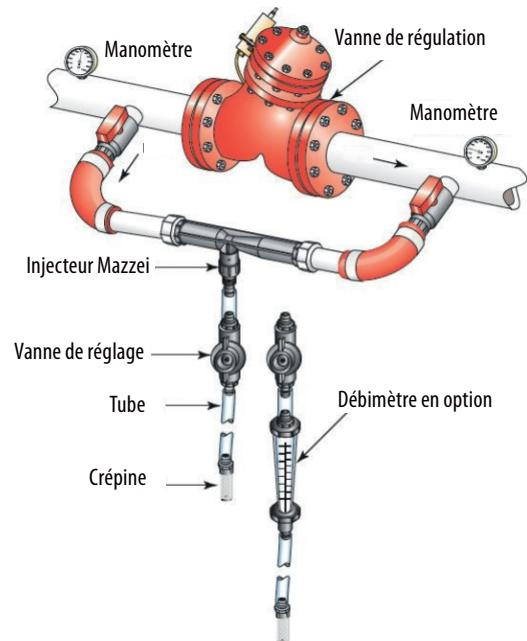
Schéma 1 et 2 : Injecteur installé autour d'un point de restriction telle une vanne de régulation ou une vanne d'arrêt qui créé une pression différentielle, entraînant par conséquence l'injecteur à produire un vide.
