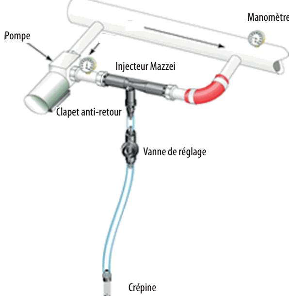
Schéma 3 : Injecteur installé simultanément à une pompe centrifuge pour augmenter la pression et le vide d'aspiration de l'engrais en aval de la pompe.
