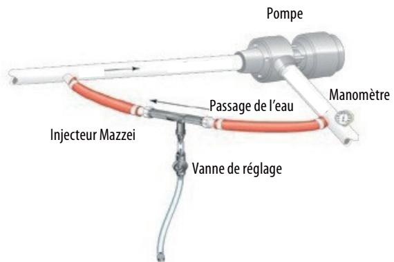
Schéma 4 : Injecteur installé à cheval sur la pression différentielle d'une pompe. Il est monté dans le sens sortie pompe vers entrée pompe.
