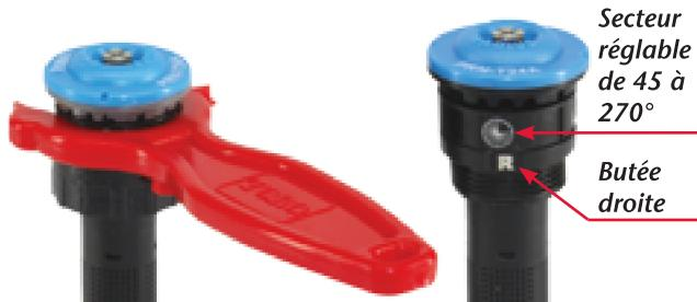
La méthode unique de réglage permet de pré-régler à la main ou avec l'outil avant installation. Des repères visuels permettent de régler rapidement le secteur entre 45 et 270°.
