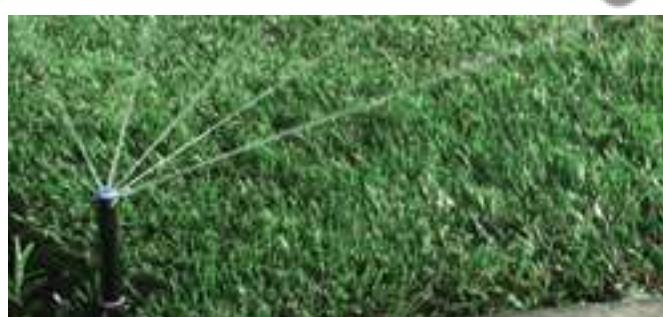
Les buses multijets Série Precision™ assurent une pluviométrie constante quelque soit le secteur d'arrosage et la portée entre 4,2 et 7,9 m. L'eau est apportée lentement et uniformément pour réduire le ruissellement et le gaspillage d'eau.
