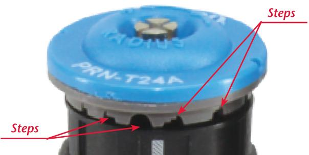
La technologie Step-Up™ est développée pour assurer une haute uniformité d'arrosage depuis le pied de la buse jusqu'à l'extrémité du jet. Les "Steps" unique créent 15 jets de portées différentes chacun dévolu à une partie de la surface à couvrir.
